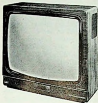
Afb. 1 - Grundig Color 8050 TD, één van de modellen uit de reeks KTV's met afstandsbediening 'Tele-Dirigent'. Onder het beeld is o.m. een nixie-buisje toegepast, waar de programma-keuze zichtbaar wordt gemaakt.
